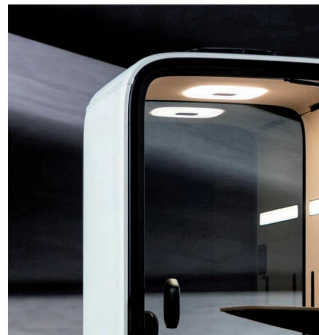
Les panneaux extérieurs thermolaqués de Framery One sont fabriqués en acier embouti. Les structures en aluminium et en acier noirs mats forment le cadre et le verre feuilleté insonorisant complète le support structurel. L'habillage intérieur remplaçable est fabriqué avec un matériau insonorisant en PET. Le sol est recouvert par une moquette bouclée rase antistatique et anti-taches.
